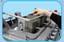
在入口料斗周围 设置有紧急停止把手。 降低把手会使机械停止。
