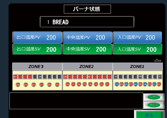
▲トラッキングシステムの画面表示（菓子パンの場合は上火あり）
