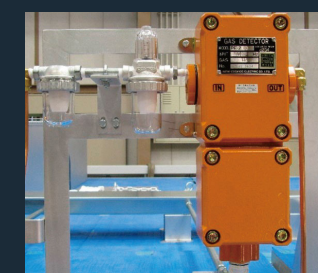
▲ ガス漏れ警報器
